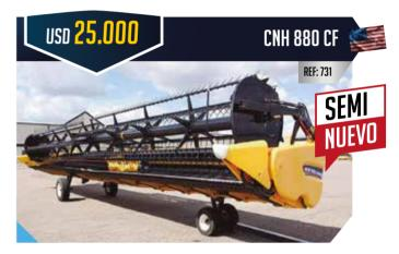
Origen: USA - **Cabezal de 40 pies de lona**, doble caja de mando de cuchillas (ubicadas al centro), volante de molinete helecoidal, barra de corte flexible, ruedas patines y con kit de ruedas para transporte.
