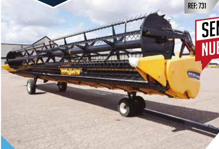
Origen: USA - **Cabezal de 40 pies de lona**, doble caja de mando de cuchillas (ubicadas al centro), volante de molinete helicoidal, barra de corte flexible, ruedas patines y con kit de ruedas para transporte.
