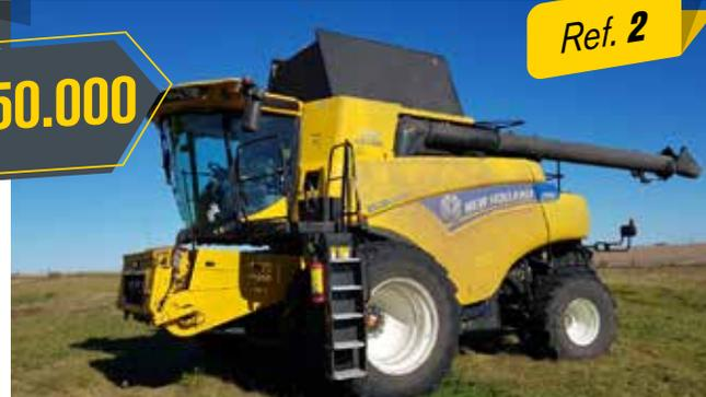
Origen: Bélgica - 4x4 - Rod. del. 580/85 R42 dual, rod. tras. 750/65 R26 - Desparramador SYRA - Picador de pajas Piloto - Tolva eléctrica - Pico eléctrico del tubo de descarga
